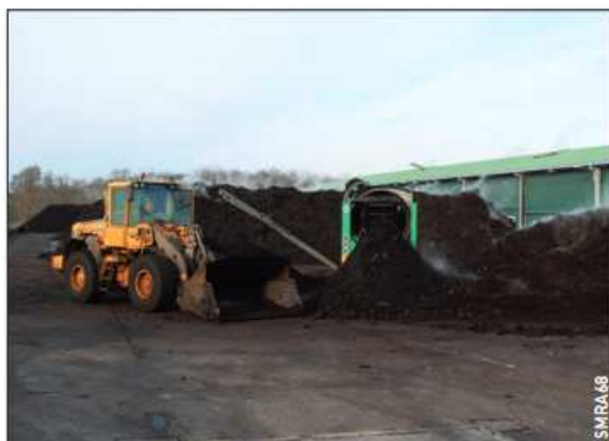
Plateforme de compostage des boues
