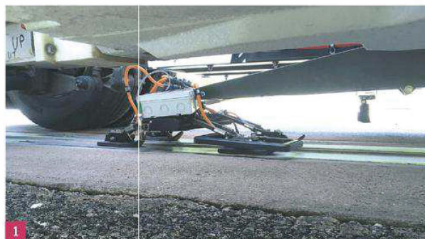
1. Un patin disposé sur le plancher du véhicule permet la mise en contact électrique avec le rail. 2. Alstom teste cette nouvelle technologie sur une piste d'essai de 308 m à Göteborg, en Suède.
