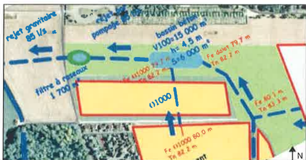
Figure 1. Schéma de principe du scénario indiqué au dossier « police de l'eau » [ANTEA, 2005] : bassin béton profond de 4,5 m + pompage vers filtre planté + rejet gravitaire
